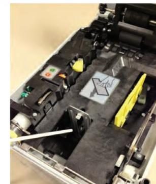
4. Poussez la plaque de billets vers le bas du chargeur (jusqu'à la butée) et soufflez avec de l'air comprimé
