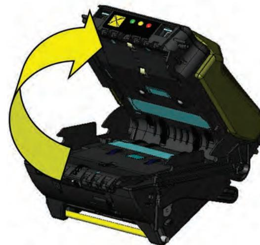
4. En utilisant de l'air comprimé (bombe d'air sec ou petit compresseur sur soufflé léger), soufflez la poussière ou les débris des capteurs de lumière et des capteurs de reconnaissance sur les parties supérieure et inférieure de l'accepteur.
